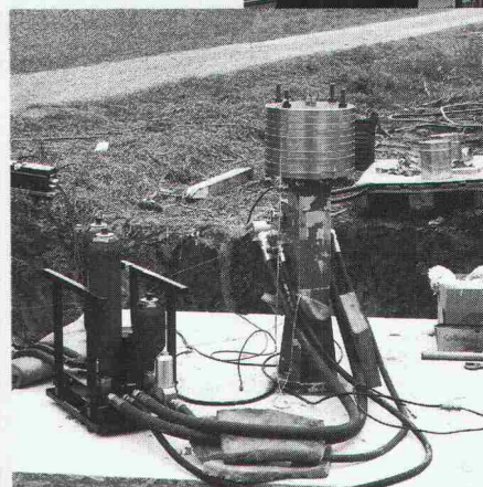
Schwingungserregung einer Fundamentplatte.
