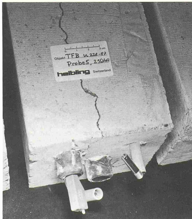
Bild 10. Betonprisma 5 mit 2% Chlorid und einem Schutzstrom von 5 mA/m 2 (geringere Rissbildung gegenüber Bild 9)
