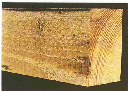
Bild 3. Schwächung des Holzes durch sog. Druckholz oder Buchs
