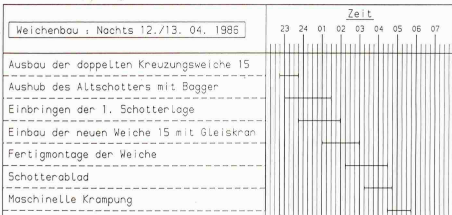
Bild 2. Ablaufplanung für den Weichenumbau
