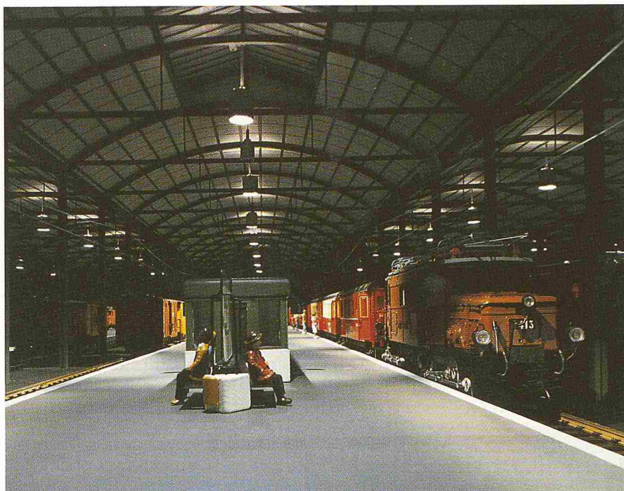
Bild 3. Beleuchtungsversuch am Modell (Foto P. Bartenbach, München)
