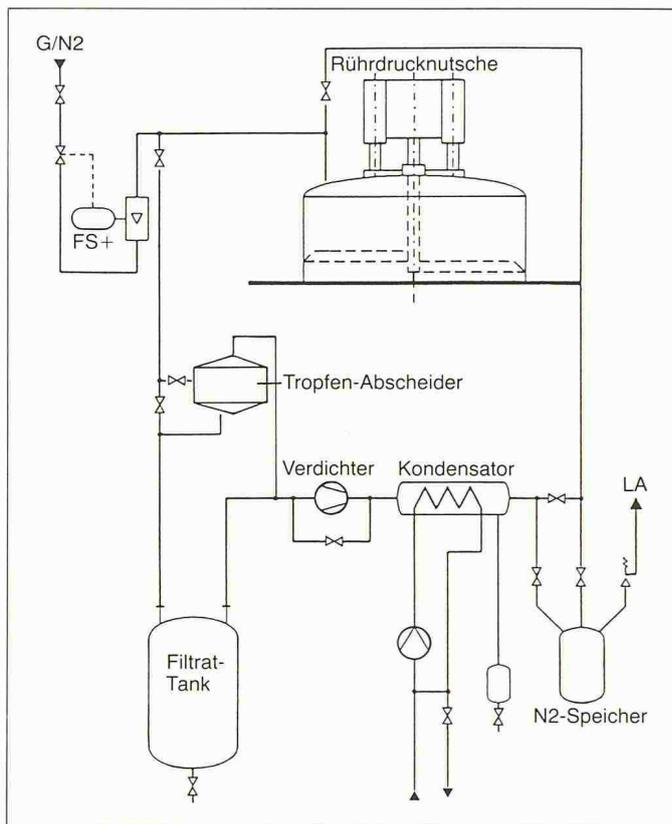
Bild 12. Rührdrucknutsche; Konzept für geschlossenen Gaskreislauf beim Entlasten und Entfeuchten
