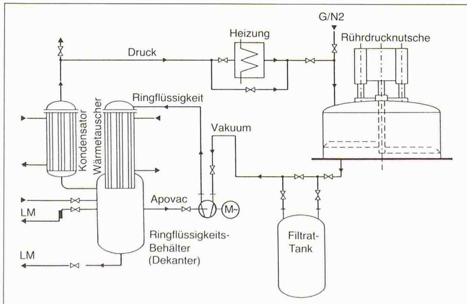
Die Ringflüssigkeit in der Pumpe stellt dabei das auskondensierte Lösemittel dar.
