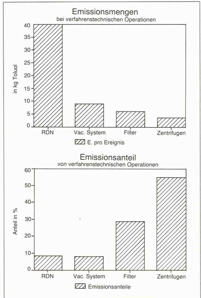
Bild 4. Emissionsmengen und Emissionsanteile bei verfahrenstechnischen Operationen
