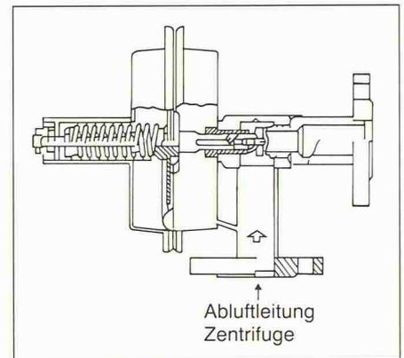
Bild 6. Gewichtsbelastetes Druckhalteventil
