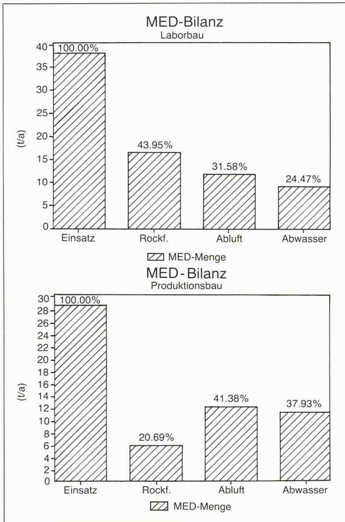
Bild 2. MED-Verteilung in einem Labor- und Produktionsbau
