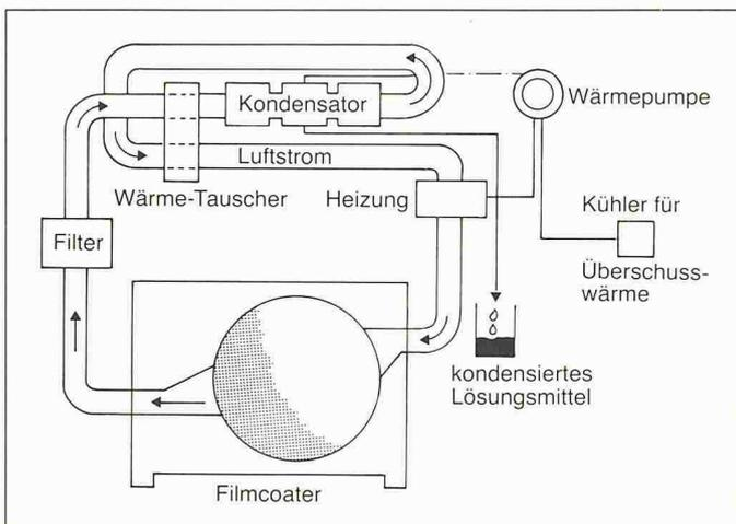
Bild 10. Schematische Darstellung des Filmcoaters mit geschlossenem Gaskreislauf
