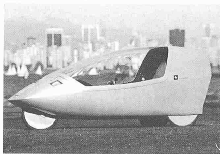
Der an der ETH Zürich entwickelte Prototyp des «Twike», ein mit Muskelkraft angetriebenes Leichtfahrzeug
