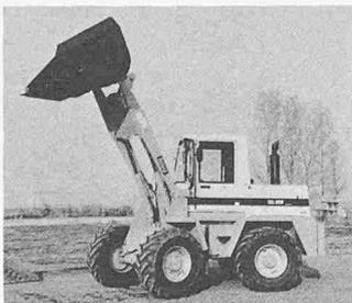
Lader mit einem wassergekühlten Perkins-Vierzylinder-Dieselmotor haben oder mit einem luftgekühlten Deutz in gleicher Bauart. Beide leisten 54 kW bzw. 74 PS 2,200 U/min.
