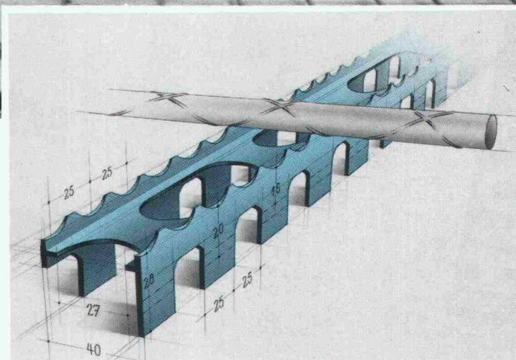
Profilgrößen: Der vertikale Armierungsabstand zur Schalung ist konstant und abhängig vom Profil-Typ. Lieferbar in 3 Größen mit den Abständen von 15, 20 und 28 mm. Verlangen Sie bitte unseren Prospekt mit Mustern.
