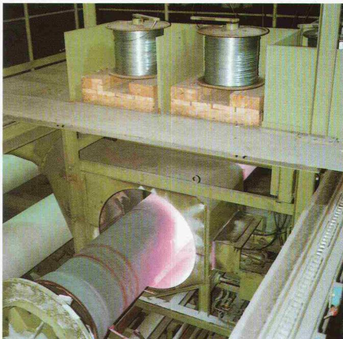
Beim Flammverzinkungsverfahren wird ein Zinkdraht (99,99 % reiner Zink) in einem elektrischen Lichtbogen zu feinen Zinktröpfchen aufgeschmolzen und direkt nach dem Glühofen auf die Oberfläche des noch heissen, rotierenden Rohres gestäubt.
