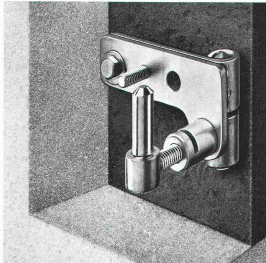
Profitieren Sie jetzt von der Arbeit, die schon im Baukörper steckt: verlängern Sie einfach den Kloben. Stecken Sie die HESCO-Klobenverlängerung auf den alten Kloben. Bohren Sie ein Loch und verankern Sie die Klobenverlängerung im Mauerwerk. Und schon ist die Arbeitszeit wesentlich verkürzt.
