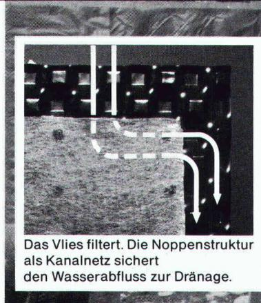
Das Vlies filtert. Die Noppenstruktur als Kanalnetz sichert den Wasserabfluss zur Drainage.
