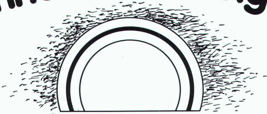
**Ob konventioneller Sprengvortrieb oder Tübbingbauweise, VATAG bietet anforderungskonforme Folienabdichtungen, sei es in loser Verlegung, sei es ganzflächig aufgeklebt. Die patentierte «Drainageverklebung» dient der Ableitung von Wassereintrüben.**
