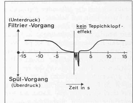
Bild 9. Druckverlauf bei Spülluftabreinigung «off-line»
