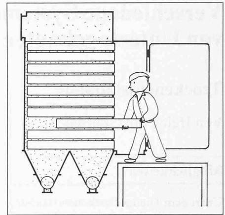
Bild 6 (oben). Flachslauch-Wechsel
