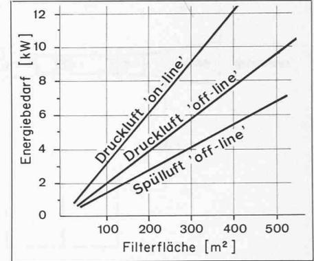
Bild 14. Energiebedarf verschiedener Filtersysteme
