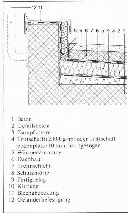
Bild 2. Befahrbares Flachdach auf Mehrzweckturnhalle mit Trittschallisolation
