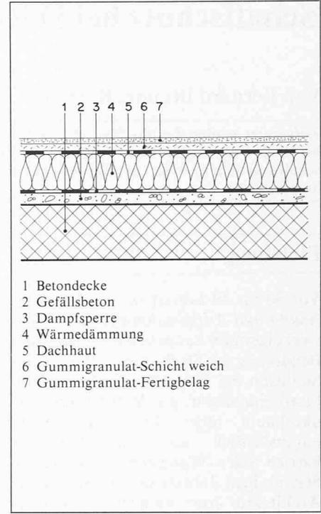
Bild 3. Begehbare Flachdachaufbau mit Trittschallisolationsschicht über der Wasserisolation
