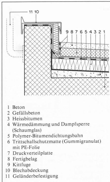
Bild 4. Befahrbares Kompaktdach mit Trittschallschutzmatte über der Wasserisolation
