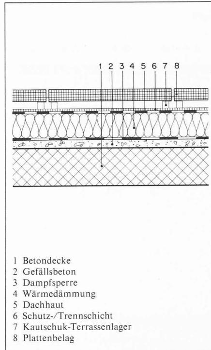
Bild 5. Begehbares Flachdach mit Dachplatten auf Gummilagern
