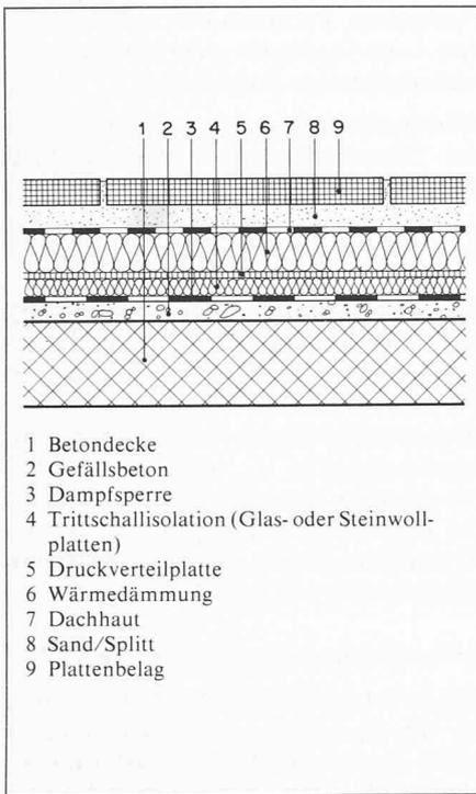
Bild 1. Prinzipieller Aufbau eines begehbaren Terrassenflachdaches mit Trittschallisolation
