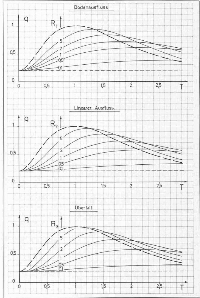
Bild 3. Retentionskurven  $q(T)$  für  $q_0 = 0,2$
