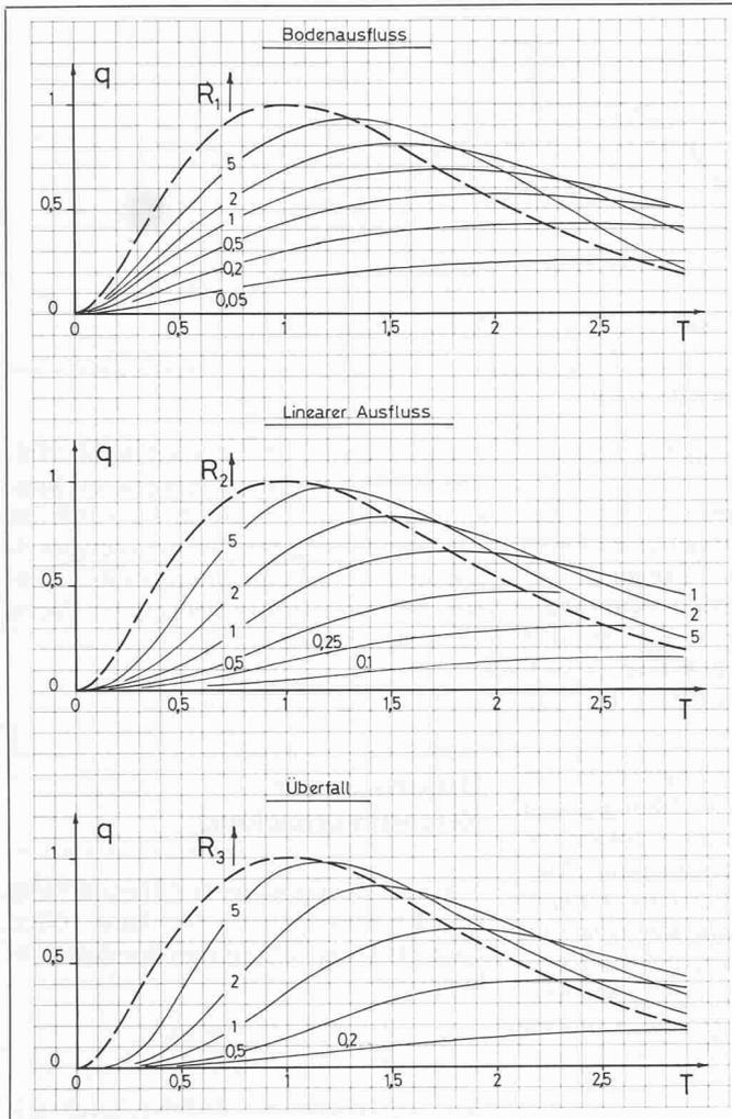
Bild 2. Retentionskurven  $q(t)$  für  $q_0 = 0$
