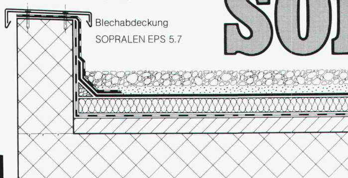
Schutzschicht SOPRALEN EJ 3.5 + EV 3.2 Wärmedämmschicht Dampfsperre
