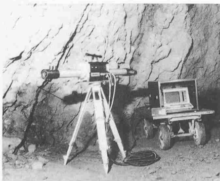
Bild 1. Profilmessgerät (A. MT. Profil) im Tunnel
