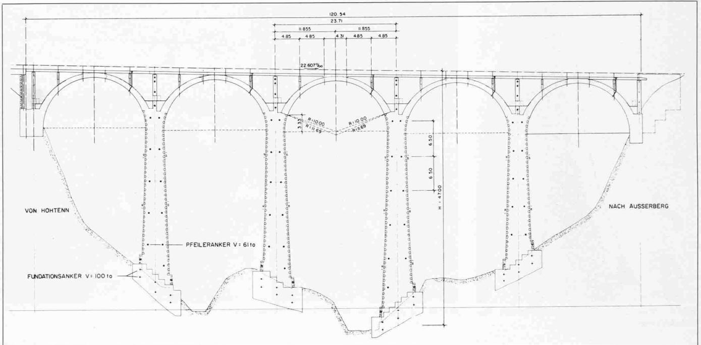
Bild 5. Längsschnitt durch neuen Viadukt
