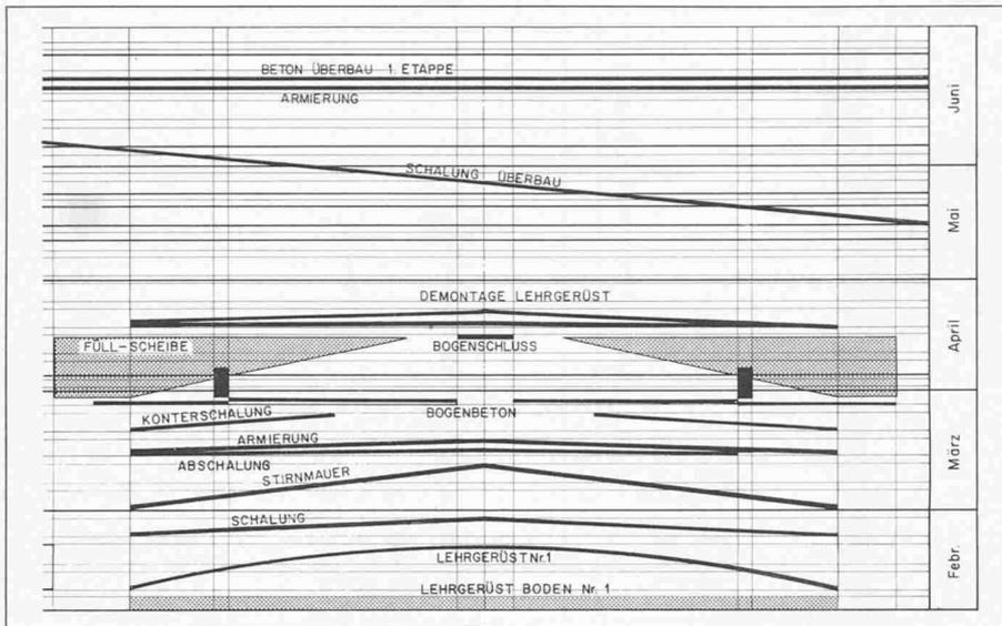
Bild 11. Bauprogramm für ein Feld des Überbaus
