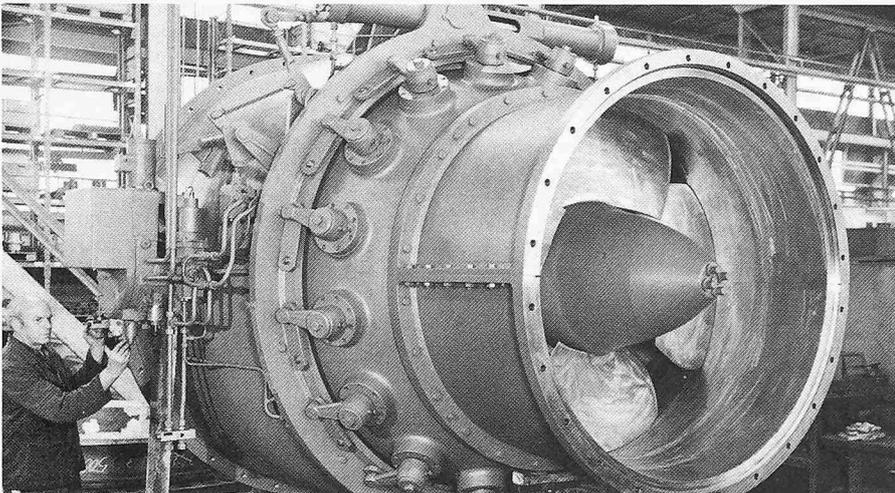
Doppeltregelbare (4 Laufschauflern, 16 Leitschauflern) Escher-Wyss-Kaplanrohrturbinen mit Kegelradgetriebe
