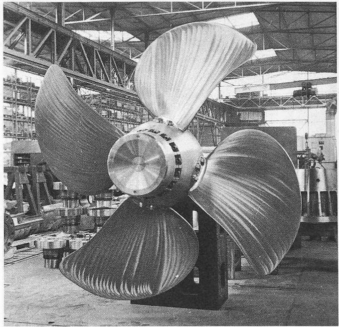
Schiffspropeller (verstellbar) mit sogenannten «Skew»-Schaufeln
