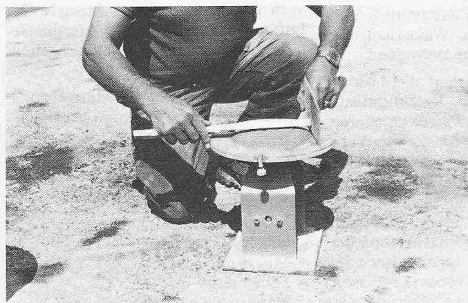
Bild 4. Messung des Ausbreitmasses nach DIN 18555
