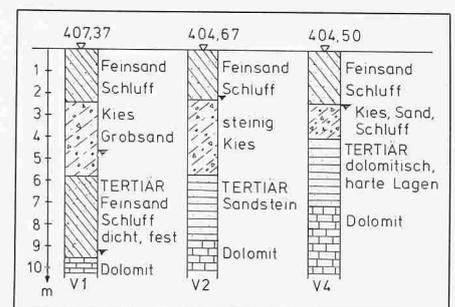
Bild 1. Bohrprofile im Kühlturbereich
