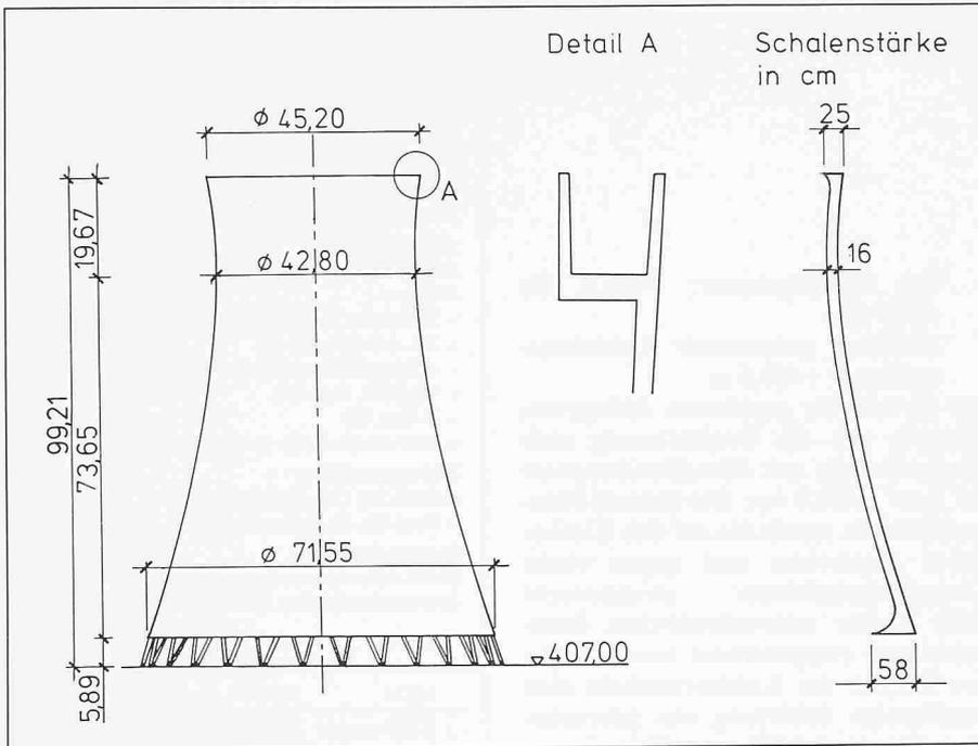
Bild 3. Schalenabmessungen
