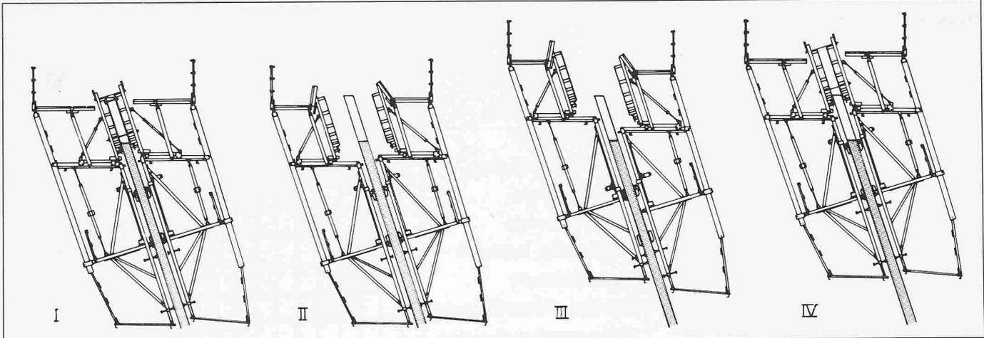
Bild 7. System der Kletterschalung, Phasen I bis IV
