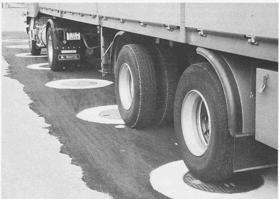
Bild 3. Anordnung der Belastungsversuche mit einem Sattelschlepper
