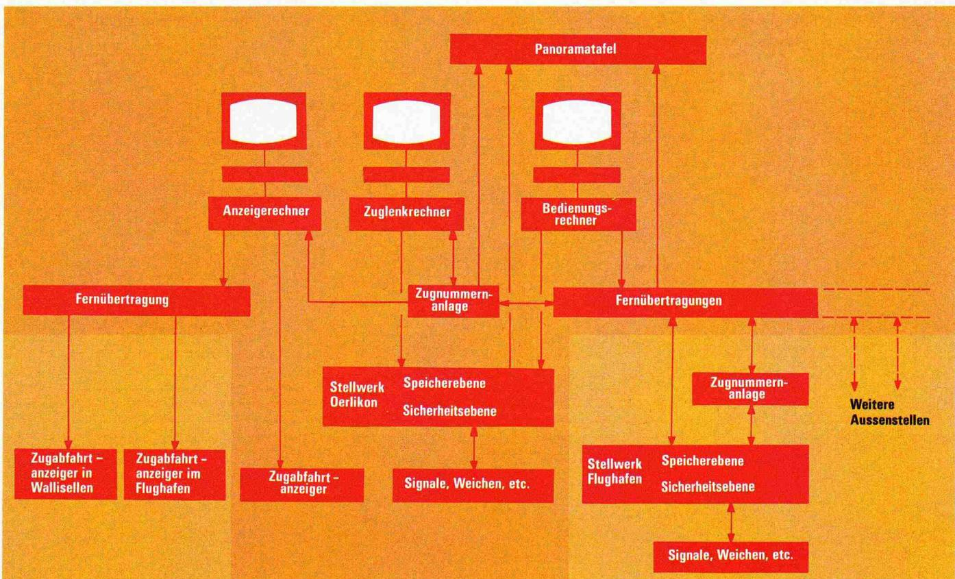
Bild 4. Rechnerkonfiguration im Fernsteuerzentrum Zürich Oerlikon
