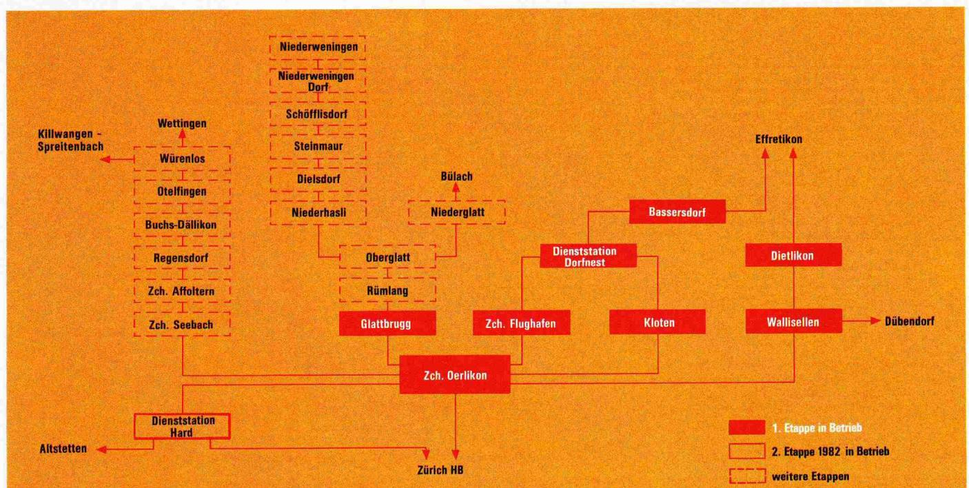
Bild 1. Fernsteuerzentrum Zürich Oerlikon. Schema und Ausbauetappen
