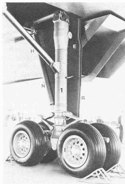
Bild 11. Linkseitiges Haupt-Fahrgestell des Überschallflugzeuges «Concorde». 1: Haupt-Zylinder des Fahrgestells mit eingebauter Stossdämpfung (siehe Bild 12); H: Hilfs-Zylinder für das Einziehen des Fahrgestells während des Fluges ins Innere des Flugzeugflügels; N: zweiter Hilfszylinder; E: grosses, zum Herunterlassen des Fahrgestells aufklappbares Segment der Flügel-Unterseite.
