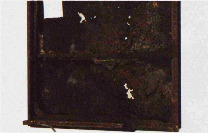
Bild 7. Aufgeschnittenes Fassadenelement mit Perforationen am Aussenblech (PUR-Schaumstoff entfernt)
