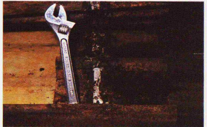
Bild 12. Geöffnete Überlappung mit Überresten eines Dichtungsbandes. Sehr starke Korrosion bis zur Perforation im Bereich der Überlappung
