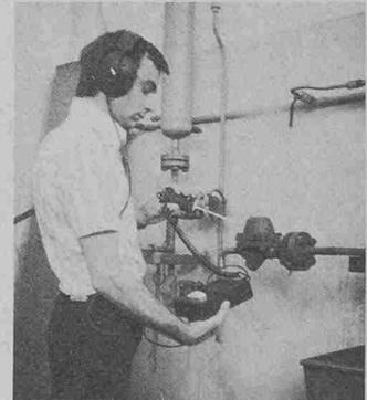
tors verglichen. Der Unterschied der beiden Signale ist ein Gemisch von Frequenzen im hörbaren Bereich, ein Geräusch also, das sich je nach den von der Sonde aufgenommenen Frequenzen ändert. Fliesst z. B. Kondensat durch einen Kondensatableiter, lässt sich ein gurgelndes Turbulenzgeräusch hören. Ein kontinuierlicher Ton mit grossem Zeigerausschlag am Steuergerät aber zeigt an, dass der Kondensatableiter «durchschlägt», also dauernd Frischdampf verliert.
