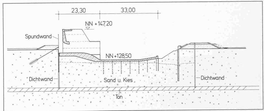
Bild 3. Schnitt durch das Staubalkenwehr
