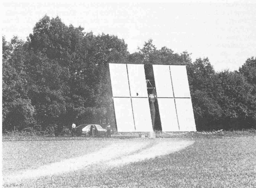
*Heliostat (Sonnenkraftwerkspiegel), im Eidg. Institut für Reaktorforschung in Würenlingen aufgebaut. Mit ihm soll geprüft werden, welchen Beitrag Sonnenkraftwerke in den Schweizer Alpen zur Energieversorgung liefern können. Für eine längere Messkampagne wird der Heliostat anschliessend auf Weissfluhjoch bei Davos montiert.*
