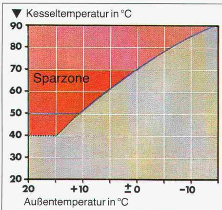
zung kann der Heizkessel praktisch das ganze Jahr im Niedertemperaturbereich betrieben werden.
