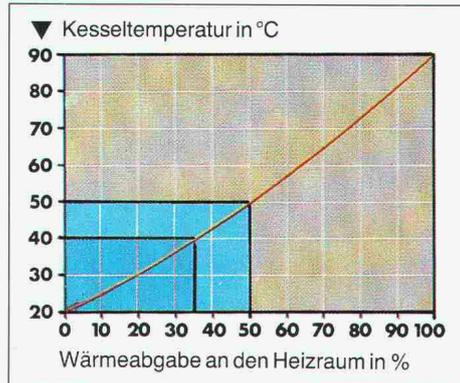
den Betriebszeit (60–70% des Jahres) mit einer abgesenkten Temperatur betrieben. Je geringer der Temperaturunterschied zwischen Kessel und Umgebung, desto geringer auch die Stillstandsverluste.
