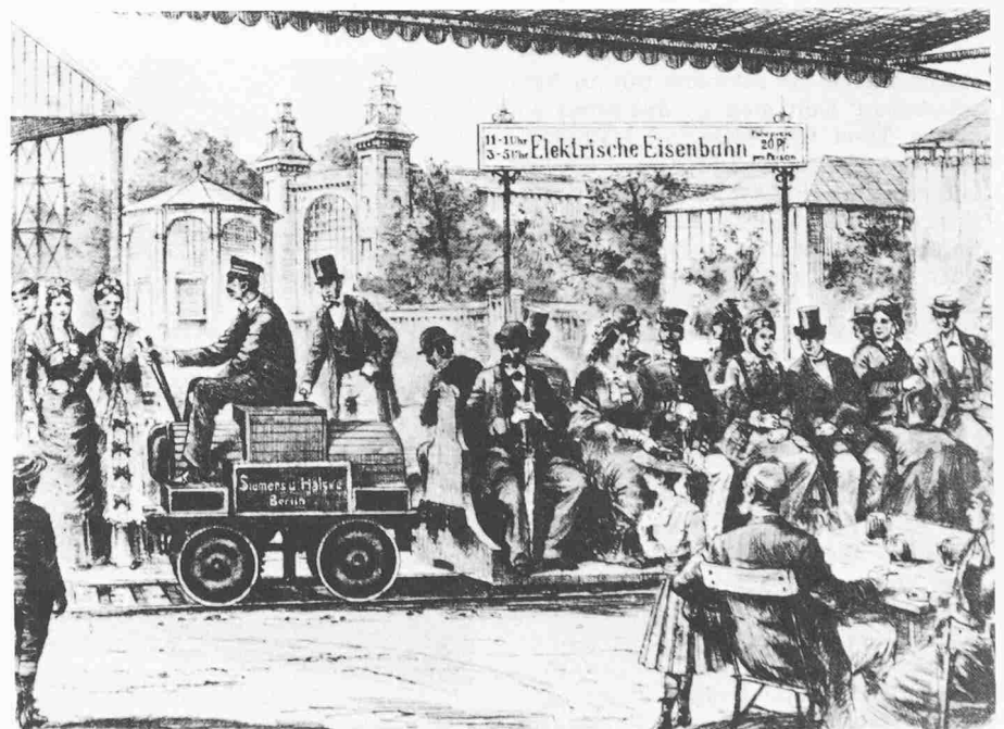
Auf dem Gelände der Berliner Gewerbeausstellung setzte sich am 31. Mai 1879 zum erstenmal ein Schienenfahrzeug mit Hilfe von Strom und Elektromotor in Bewegung. Werner von Siemens hatte diese erste elektrische Lokomotive der Welt konstruiert. Sie zog drei kleine sechssitzige Wagen über eine 300-Meter-Rundstrecke. Der geglückten Premiere vom 31. Mai folgten während der Dauer der Ausstellung noch rund 5000 weitere Fahrten
