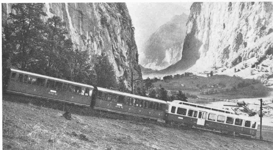
Bild 1. Zug der Wengernalpbahn mit elektrischem Zahnrad-Triebwagen ABDhe 4/4 und Vorstellwagen
