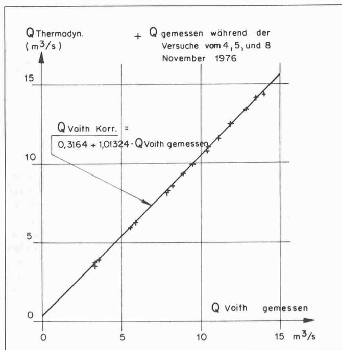
Bild 4. Bestimmung des wirklichen Durchflusses der Isogyre - Turbine, Verhältnis zwischen Durchflussmessung Voith und thermodynamischer Messung (Eichung)
