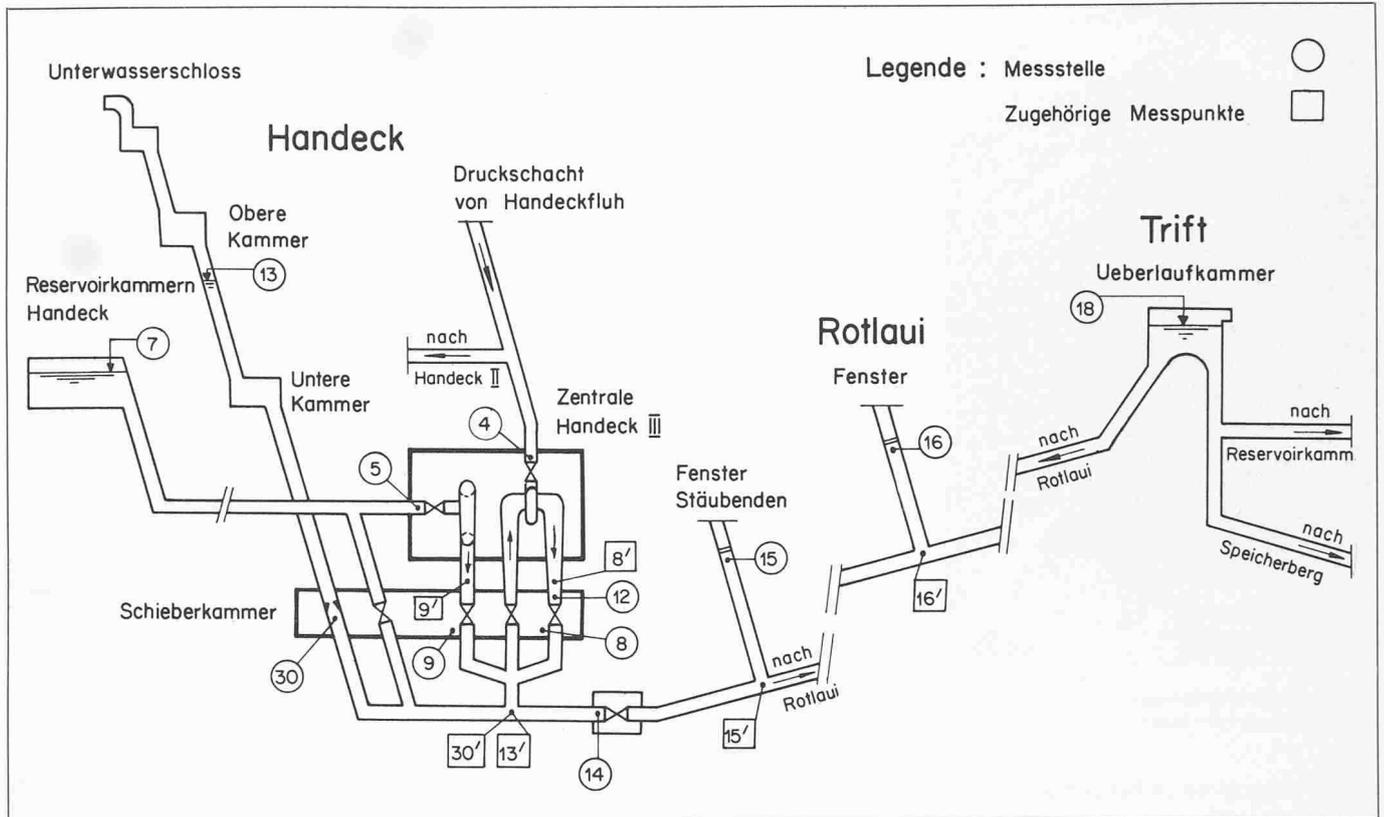
Bild 3. Druckverlustmessungen vom September und November 1976, Schematische Darstellung der Messpunkte. 4, 5, 14, 15, 16, 30: Gewichtsmannometer, 7: Pegel, 8: Ultraschall-Durchflussmessgerät Voith (Isogyre-Turbine), 9: Ultraschall-Durchflussmessgerät Voith (regulierbare Pumpe), 18: festinstallierte Druckwaage Rittmeyer
