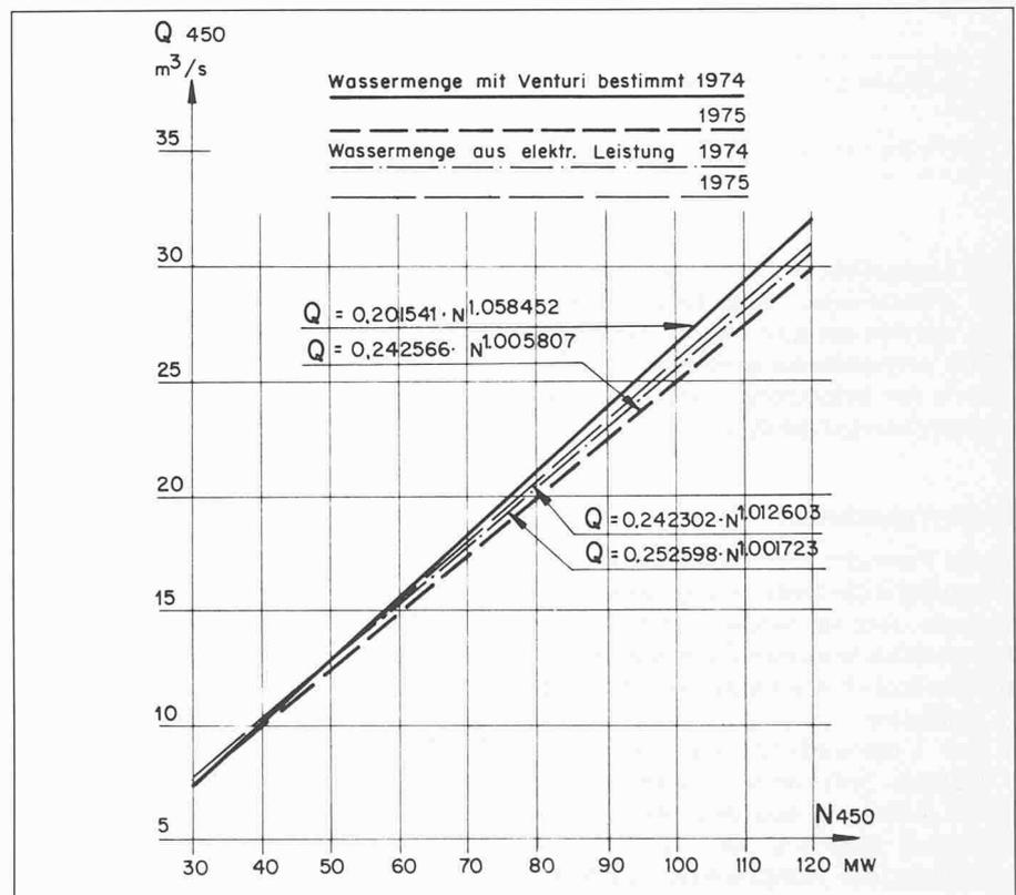
Bild 2. Leistung in Funktion der Wassermengen (mit Venturi und aus elektr. Leistung bestimmt), Messungen 1974 und 1975 - H Netto = 450 m
