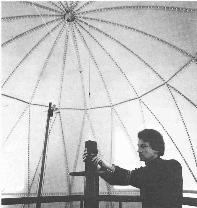
Bild 2. Aufstellen eines Prüflings auf dem Drehtisch der Plattform, im Hintergrund die verstellbare Messantenne
