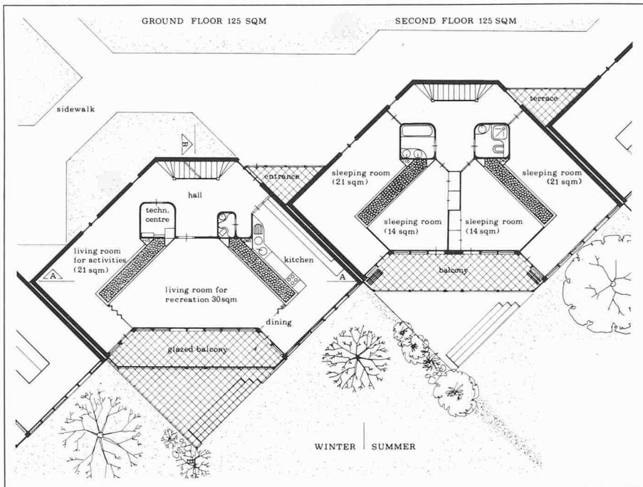
Grundriss des «Solar Trap»-Hauses; links: Erdgeschoss mit verglaster Terrasse (Winter); rechts: Obergeschoss mit offenem Balkon (Sommer)
