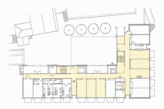
Grundriss des CSO: Hauptgebäude, Eingangsniveau im obersten Stock (unten), Piazza, Casa Moschini (oben links), Bocciabahn (angeschnitten am linken Bildrand), Verbindung zum Dorf (oben rechts). Farblich hervorgehoben der offene Eingangsbereich, der gleichzeitig als zentrale Verkehrsfläche und als Aufenthaltsort der Bewohnerinnen und Bewohner dient und Sichtverbindungen auf die Piazza, auf die Landschaft und in die offene Küche bietet
