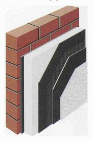
Der Mantel eines Wärmedämm-Verbundsystems schützt das Haus vor Wärmeverlust. Als Schlussbeschichtung stehen individuell gestaltbare Deckputze zur Verfügung
