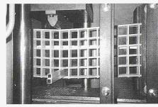
GFK-Gitterrost in Prüfmaschine
