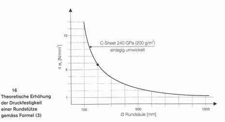
Die Bemessungstabelle (Bild 16) zeigt die theoretische Erhöhung der Druckfestigkeit einer Rundsäule in Abhängigkeit einer C-Sheet-Umwicklung gemäss dem vorgenannten Bemessungsansatz. Die Druckfestigkeit einer Rundsäule des Durchmessers 400 mm, die mit fünf Lagen C-Sheet (240 kN/mm<sup>2</sup>) umwickelt wird, kann laut Bemessungsmodell um  $5 \times 5.7 \text{ N/mm}^2 =$ 28,5 N/mm² erhöht werden.
