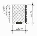
Kennwerte der C-Sheet-Umwicklung: E-Modul: 640 kN/mm<sup>2</sup> Zugfestigkeit: 2 650 N/mm<sup>2</sup> Bruchdehnung: 0,4% Gewicht (unidirektional): 400 g/m<sup>2</sup> Breite C-Sheet-Band: 300 mm
