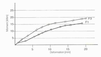
Versuchsbalken mit aufgeklebter CFK-Lamelle und C-Sheet-Umwicklung
