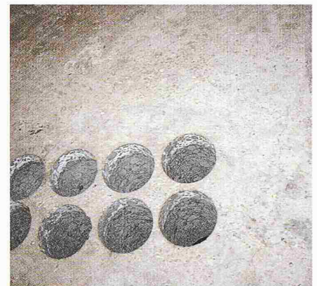
5 Beton mit erhöhter Brandbeständigkeit nach Brandbelastung
