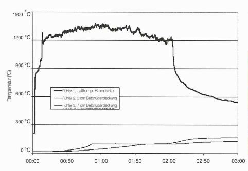
Temperaturverläufe bei Brandprüfung
