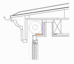
Einbau von Vakuum-Dämmplatten in einen Rollladenkasten
