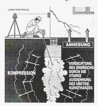
Erhöhung der Tragfähigkeit des Untergrundes Hebekraft bis über 50t/m³
