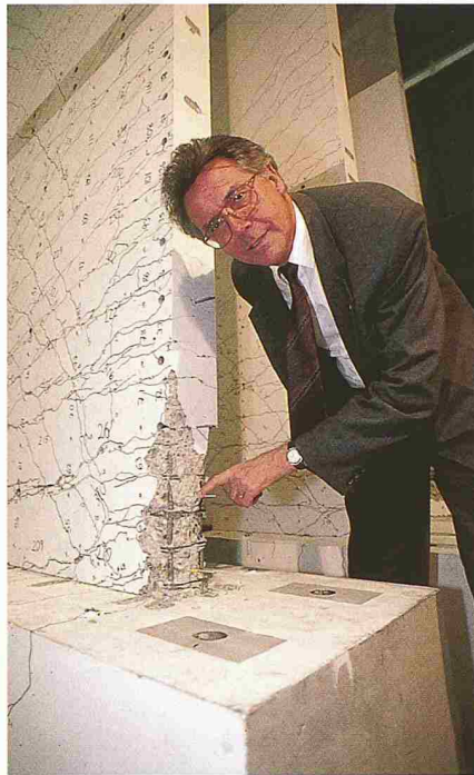
Hugo Bachmann vor einer duktil gestalteten Stahlbetonversuchswand, die einen Erdbebenversuch gut überstanden hat (Bild: Martin Heilmann)
