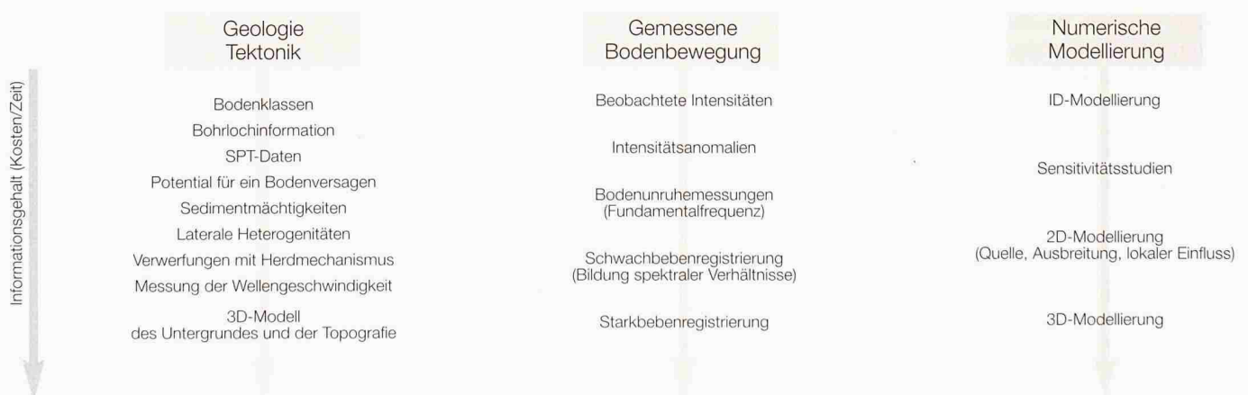
Zonierung und Mikrozonierung in Gebieten mit geringer Seismizität: schematische Darstellung der in der Mikrozonierung anwendbaren Verfahren (Grundlagendaten: Regionale Gefährdung)
