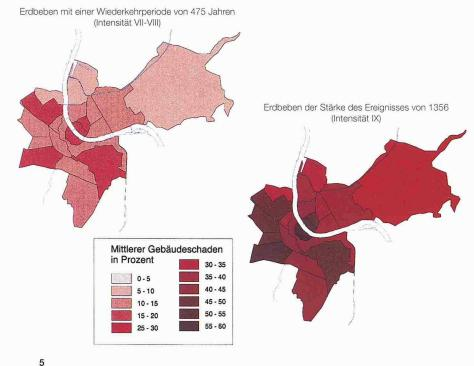
Vergleich der Schadensbilder für ein Beben mit einer Wiederkehrperiode von 475 Jahren ( $I_o = VII - VIII$ ) und für eine Wiederholung des Bebens von 1356 ( $I_o = IX$ ). In letzterem Fall ist mit dem Einsturz von etwa 4% und einem durchschnittlichen Totalverlust von rund 20% der Gebäude zu rechnen
