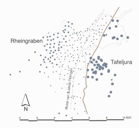
Gemessene Resonanz-Grundfrequenzen der Lockersedimente für das Gebiet von Basel [12]. Grosse Punkte bezeichnen Resonanzfrequenzen grösser als 2 Hz, mittlere Punkte stehen für den Bereich 0,75–1,2 Hz und kleine Punkte für 0,3–0,75 Hz
