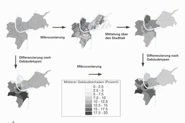
Abfolge der einzelnen Schritte von seismischer Gefährdung über Mikrozonierung und Gebäudeklassifizierung zum Schadensbild für Basel-Stadt unter der Annahme eines Bebens der Intensität VII-VIII [13]. Es ist zu beachten, dass solche Szenarien mit einer beträchtlichen Unsicherheit behaftet sind
