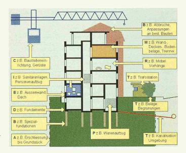
Dem Programm OGIP sind rund 2200 Datensätze von Bauelementen und Bauteilen von Umgebungsarbeiten und Fundament his zur Haustechnik zugrundegelegt
