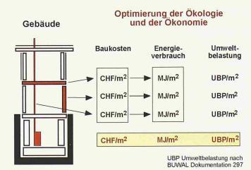
len Einheiten - z.B. ein Fenster, eine verputzte Aussenwärmedämmung oder ein wärmegedämmtes Flachdach - zusammengesetzt sind. Im Gegensatz zu blossen Baustoffen kann diesen Elementen eine Funktion zugeordnet werden, welche beispielsweise die Definition der erwarteten Lebensdauer oder die Berechnung der jährlichen Wärmeverluste ermöglicht. Werden nun die Materialien dieser Elemente mit Materialdaten, Nutzungszeiten, Öko-Inventardaten sowie mit geeigneten Bewertungsmodellen verknüpft, können
