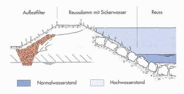
Querschnitt durch Damm mit Auflastfilter
