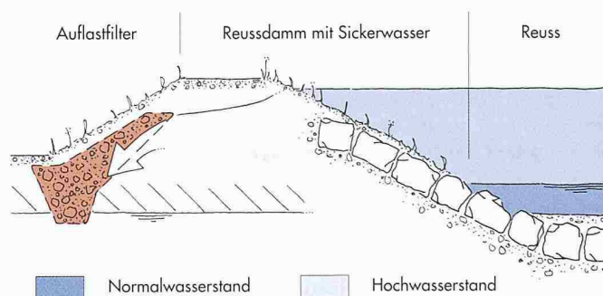
2 Querschnitt durch Damm mit Auflastfilter
