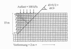
10 Deformationsmechanismus im Versuch SB10 für 15 m Wandhohe mit Auflast 100 kPa, gemäss numerischer Analyse [6]
