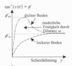
Beziehung zwischen  $\phi'$ ,  $\psi$  und  $\gamma$  als Funktion der Lagerungsdichte
