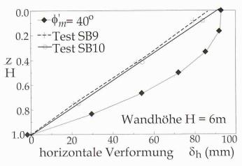
Vergleich der gemessenen horizontalen Verformungen mit der Voraussage (Tests SB9 & SB10)
