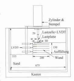
Schema und Abmessungen [mm] des Zentrifugenmodells [5, 6]
