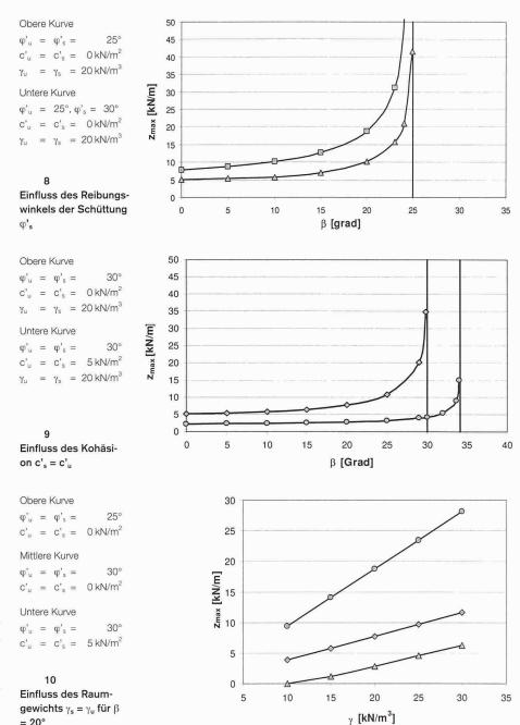
und des Reibungswinkels beeinflusst. Fällt infolge von Verwitterung, Auflockerung infolge Frost-Tauzyklen oder Wassereinfluss die Kohäsion auf nahezu Null ab und gilt  $\beta \geq \varphi'_{n}$ , nehmen die für ein Gleichgewicht erforderlichen Rückhaltekräfte enorm zu und übertreffen die Bruchlast der Geotextilien. Ein Versagen der Stützkonstruktion im Bereich der unteren Geotextillagen, unter Umständen aber auch ein Gleiten auf der Sohle oder ein eigentlicher Geländebruch kann die Folge sein.
