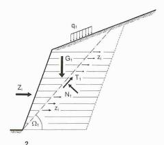
Einfacher Bruchkörper mit steiler Gleitfläche
