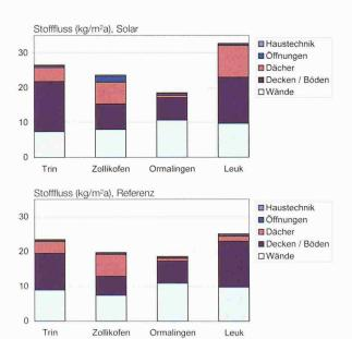
7 Stofffluss für Konstruktion. Die Stapelbalken repräsentieren die Werte aufgeschlüsselt nach Elementgruppen.
