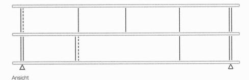
Als zweigeschossiges Scheibensystem stabile Konfiguration
