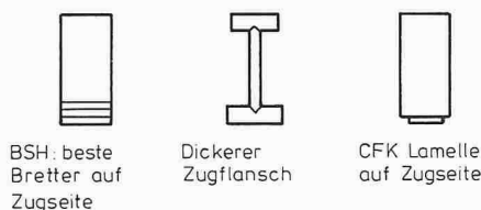
2 Vision für zukünftige Produktentwicklungen im Holzbau: einseitige Verstärkung der kritischen Zugseite
