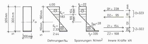
stische Berechnung zeigt ebenfalls, dass die heikle Zugzone – und nicht die duktile Druckzone – die Schwachstelle des Querschnitts bleibt.
