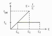
5 Trapezförmige Spannungsverteilung über den Querschnitt nach Thunell [3]
