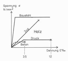
Spannungs-Dehnungs-Diagramme der Baustoffe
